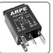
RA3214 - UNIVERSAL, VÁRIOS CLIENTES RELE AUXILIAR MINI 12V 20A 4 TERMINAIS SENDO 2 DE 2,8MM CONTATO NA
